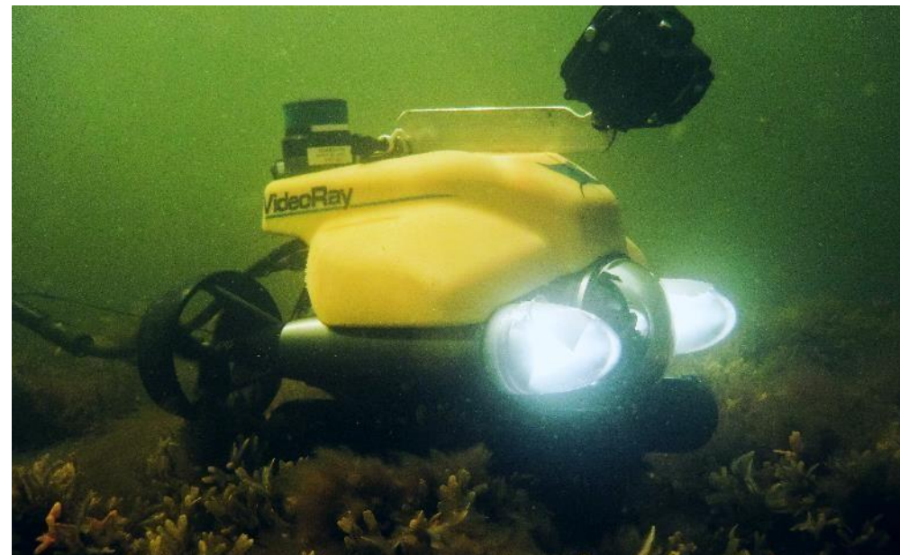
ROV kaameraga saab pildistada seal, kuhu sukelduja ei saa minna või ei mahu, nt vrakid. © Ville Karvinen
