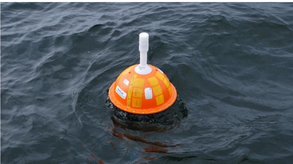
Lainepoisid kasutatakse lainekõrguse ja -suuna ning pinnatemperatuuri mõõtmiseks. © Heini Jalli
