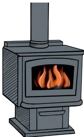
Камин воздушного отопления (без аккумуляции тепла)
